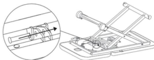
**B. Faites passer la goupille à travers le cadre en fer et le trou du moteur, puis mettez le loquet.**
